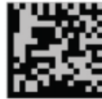
Contraste : La différence entre les éléments clairs et les éléments sombres est trop faible.
