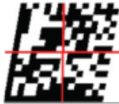
Code à barres bidimensionnel dont l' uniformité axiale est mauvaise (le ratio entre X et Y n'est pas de 1:1) ou dont l' uniformité de la grille est mauvaise (le code à barres est incliné).
