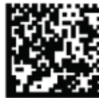
Code à barres bidimensionnel avec agrandissement de l'impression (les carrés imprimés sont trop gros) ou rétrécissement de l'impression (les carrés imprimés sont trop petits).
