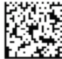
Code à barres bidimensionnel avec agrandissement de l'impression (les carrés imprimés sont trop gros) ou rétrécissement de l'impression (les carrés imprimés sont trop petits).
