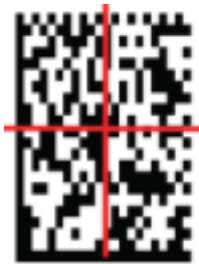
Code à barres bidimensionnel dont l' uniformité axiale est mauvaise (le ratio entre X et Y n'est pas de 1:1) ou dont l' uniformité de la grille est mauvaise (le code à barres est incliné).
